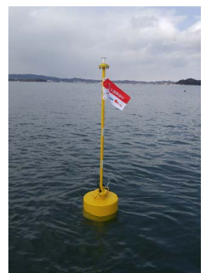
松島湾に浮かぶ水温センサ付ブイ
